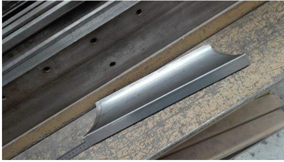
Mise en forme, vérification des dimensions
